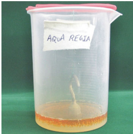
Fig. 4 Chemical etching of alloy sample in aqua regia solution
